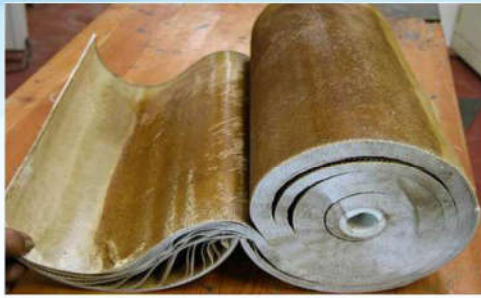
Bên trong màng RO đang vận hành Inside operating RO membrane
