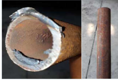
Ống thép đen trước vệ sinh Before: Ungalvanizing steel tube
